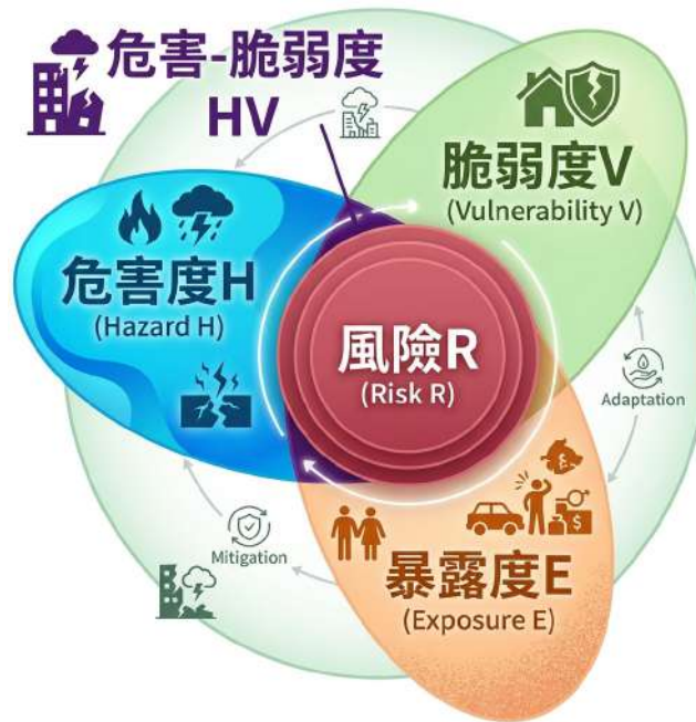
圖 1 坡地災害風險各指標定義示意圖
